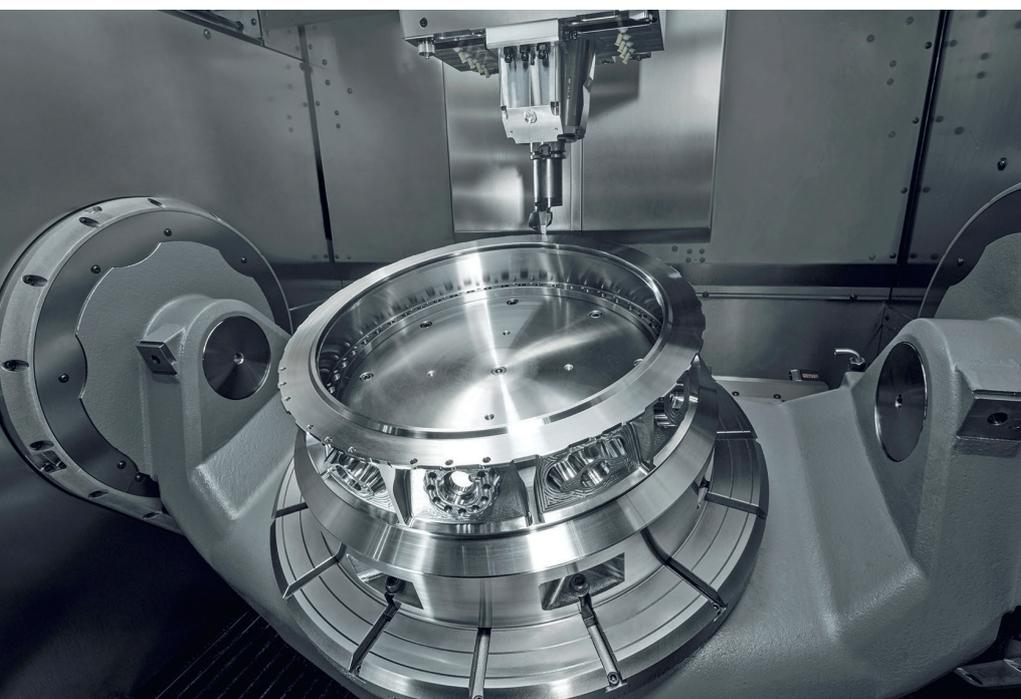
1 Bearbeitung eines Triebwerksgehäuses auf einem Fräsdrehzentrum C 42 U MT (Mill/Turn) der High-Performance-Baureihe (© Hermle)
