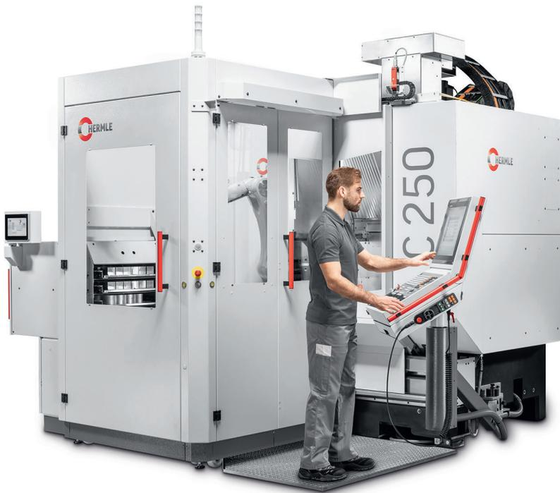
2 Das modulare und kompakte Robotersystem RS 05-2 adaptiert an einem 5-Achs-BAZ C 250 der Performance-Line (© Hermle)
